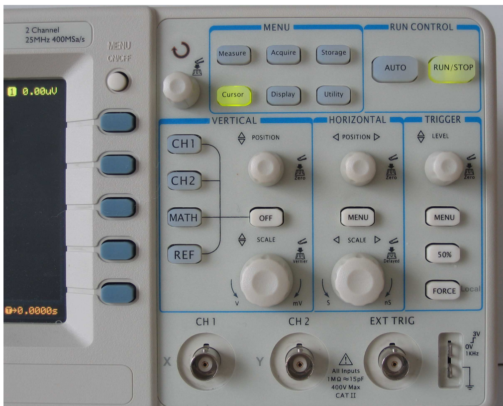
Rys.1. Fragment płyty czołowej dwukanałowego oscyloskopu cyfrowego Rigol DS1022C
